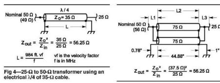
Fig 5—25- $\Omega$  to 50- $\Omega$  transformer using 75-Ω cable.
